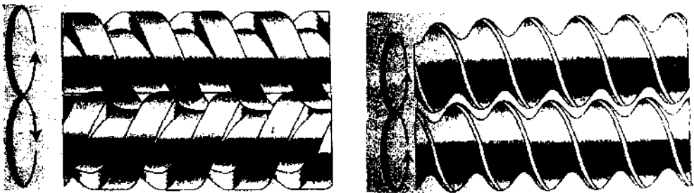
Hình 2.1.13.11 Cấu tạo trục vis của thiết bị ép đùn quay ngược chiều và quay cùng chiều
