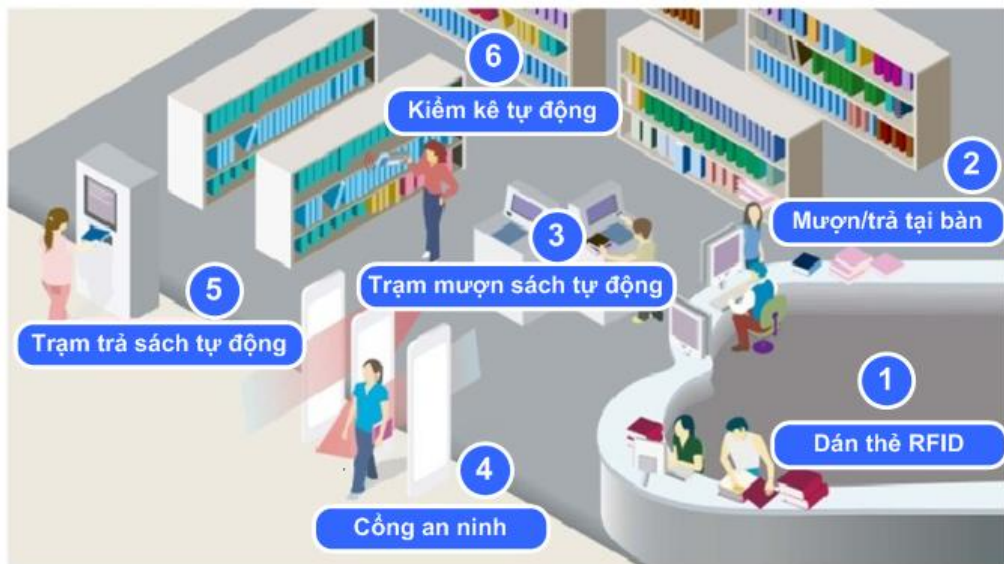
Hình 2.8 Mô hình hệ thống RFID trong thư viện
